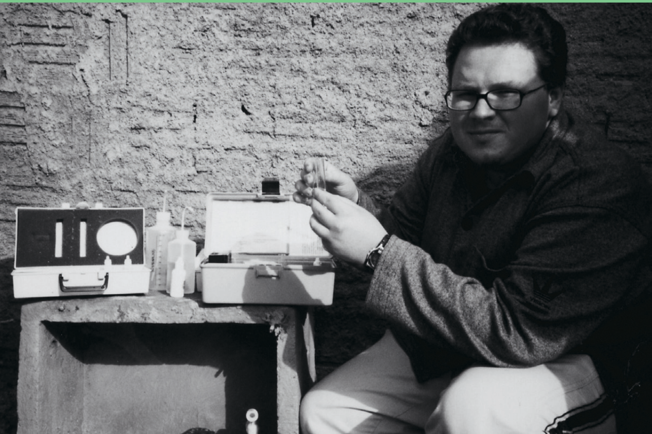
Foto 13 Medição de cloro residual na água de abastecimento no ponto de entrada nas moradias, em Espírito Santo do Turvo. Foto: Helena Ribeiro.
