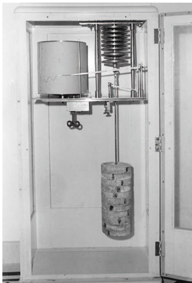
Barógrafo de Gravidade Richard Frères instalado no porão do Pavilhão do Serviço Meridiano, c. 1947.
