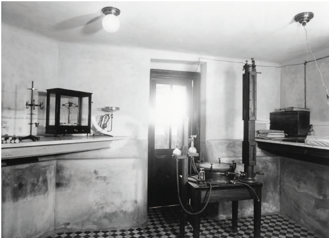
Gabinete de retificação dos barômetros. No primeiro plano vê-se uma máquina pneumática de coluna mercurial usada nessa operação, c. 1927.
