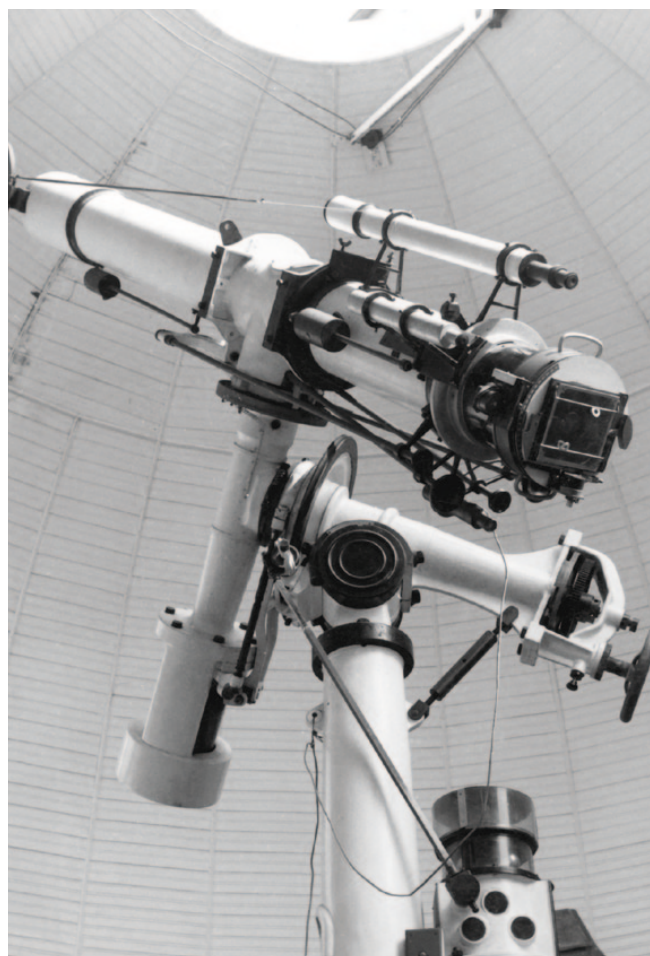
Refrator Zeiss de 175mm equipado com a câmara lunar de Markowitz, durante o Ano Geofísico Internacional 1957-1958.
